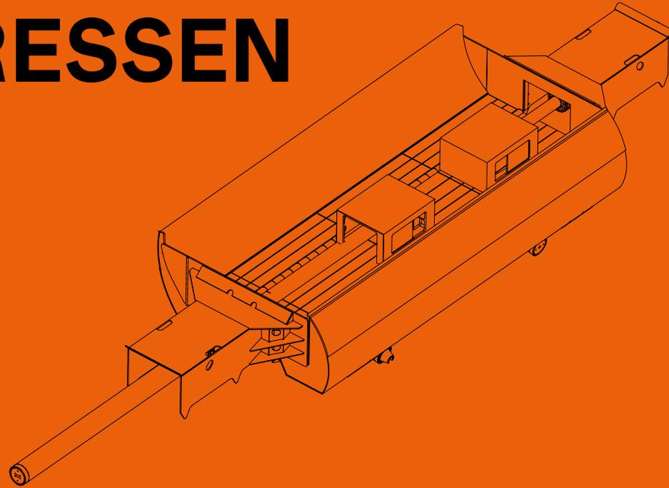
Die **LEFORT**® Pressen sind außerordentlich leistungsstarke Maschinen, die mit einem Kran ausgestattet und mittels Fernsteuerung betrieben werden können. Mit einem oder zwei Pressstempeln produzieren sie dichte Pakete in hoher Stückzahl. Die Verdichtung der Pakete ist verstellbar.
